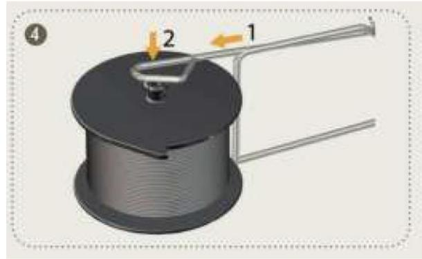
4. 將鎖臂與線軸一起推至軸座的中心，然後鬆開頂部鉤杆。
