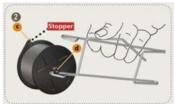
2. 將線軸軸(d)放置下側軸座, 線軸檔片(c) 置於另一側。
